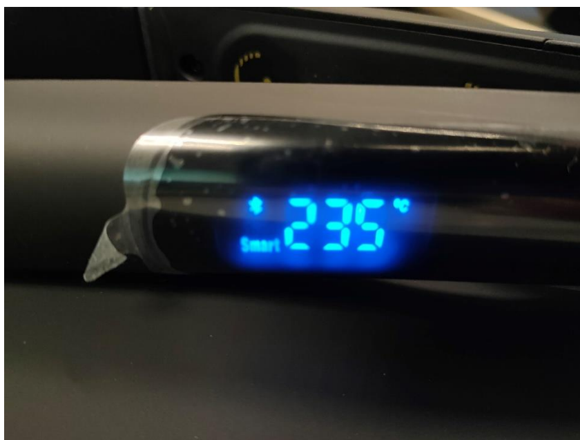
Fig. 7.1.7 寫入操作值後直髮器改變溫度
